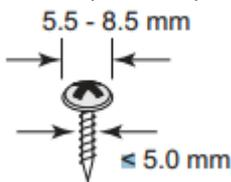
Не вкручивайте винты на всю длину – оставьте около 2 мм для того, чтобы обеспечить возможность перемещать устройство между головками винтов и стеной.
