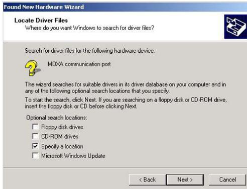
11. Вставьте компакт-диск в привод CD-ROM и укажите путь к файлу драйвера, например, **E:\Software\Win2kV1.5**, как показано ниже. Нажмите **OK**.
