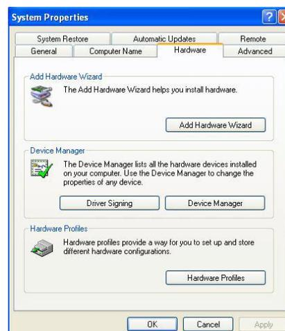
Выберите вкладку **Hardware [Устройства]** и нажмите на кнопку **Device Manager [Диспетчер устройств]**. При помощи мыши поместите курсор над подпунктом CP-104 Series в пункте Multi-port serial adapters и нажмите на ней правую кнопку. В появившемся списке выберите пункт **Uninstall [Удалить]**.
