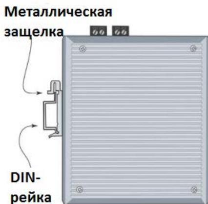
3. Чтобы снять маршрутизатор с DIN-рейки, сделайте все в обратном порядке.
