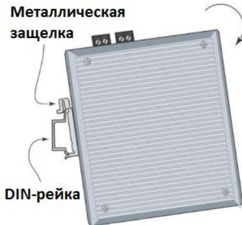
2. Крепежное устройство с характерным звуком защелкнется на рейке.
