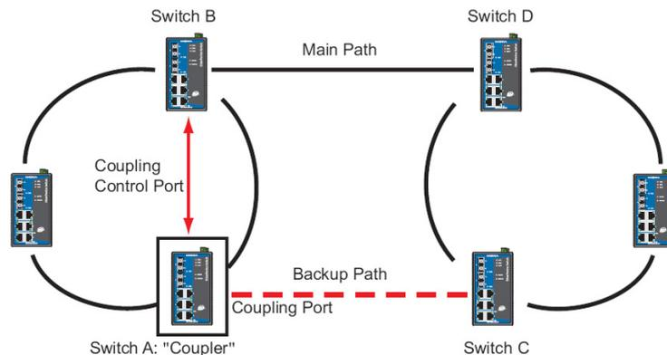
Для настройки Ring Coupling выберите два коммутатора EDS в одном кольце (например, коммутаторы А и В на приведенном рисунке) и два коммутатора в другом кольце (например, коммутаторы С и D).
