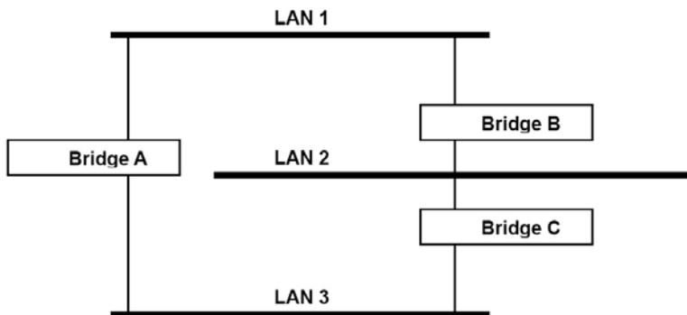
Если механизм STP активирован, он обнаружит параллельные пути и заблокирует один из них от передачи трафика. В примере показано, как STP определил, что трафик из LAN 2 в LAN 1 должен проходить через мост С и А, поскольку у этого пути большая пропускная способность, а значит, он более эффективный.
