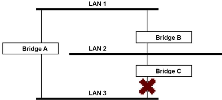
Протокол STP определит, какой путь между каждым сегментом является наиболее эффективным, и назначит корневой мост. После того, как были определены наиболее эффективные пути, другие пути будут заблокированы. На трех рисунках выше STP определил, что путь через мост С наиболее эффективен, и заблокировал путь через мост В. После сбоя моста С STP пересмотрел ситуацию и открыл путь через мост В.
