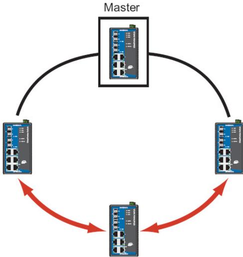
Если в кольце четное количество устройств EDS ( $2N$  EDS), то резервный сегмент – это один из двух сегментов, подсоединенный к устройству EDS  $N+1$  (коммутатору, наиболее отдаленному от «мастера сети»).
