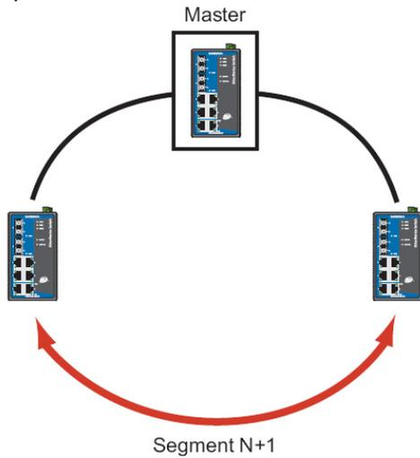
Если в кольце нечетное количество устройств EDS ( $2N+1$  EDS), то резервный сегмент – это сегмент, соединяющий устройства EDS  $N+1$  и EDS  $N+2$ .
