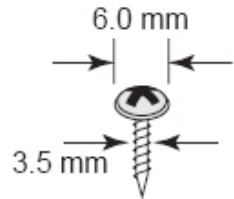
**ПРИМЕЧАНИЕ** Перед ввинчиванием болтов убедитесь, что диаметры головок стержней болтов подходят к отверстиям крепежного устройства.
