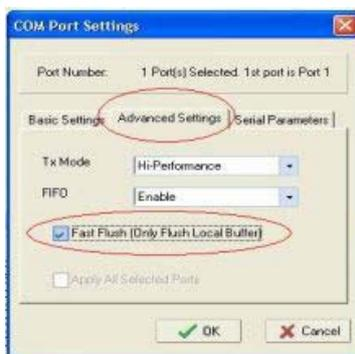
**Enable/Disable Tx/Rx FIFO.** Если отключить данный параметр, то NPort будет посылать по одному байту, каждый раз опустошая FIFO-буфер передатчика, а приёмник будет генерировать прерывание по каждому входящему байту. Это ускорит отклик канала, но понизит пропускную способность. Если вы хотите использовать контроль потока XON/XOFF, то рекомендуется отключить FIFO.
