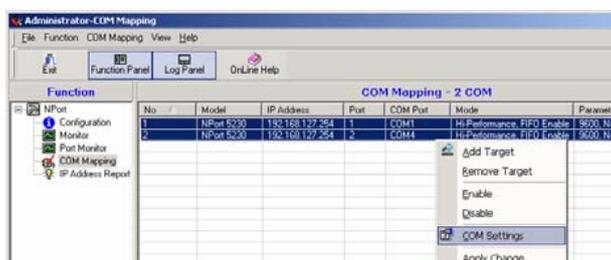
Выберите номер COM порта. Во всплывающем списке также будут отображаться все используемые и заданные номера COM. Если вы выбрали несколько последовательных портов или несколько устройств NPort, то не забудьте поставить флажок для функции «Auto Enumerating», чтобы выбранный вами номер COM порта использовать в качестве первого номера.
