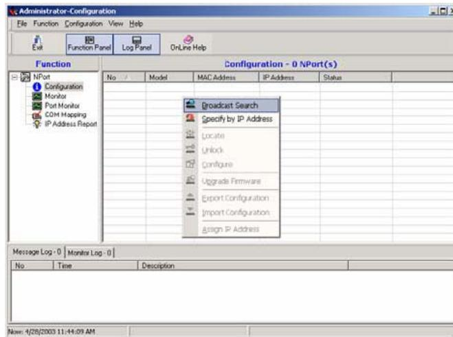
Открывшееся окно Broadcast Search содержит в себе пункты Model, IP address, MAC address и Progress (отображение процесса поиска определенного устройства)
