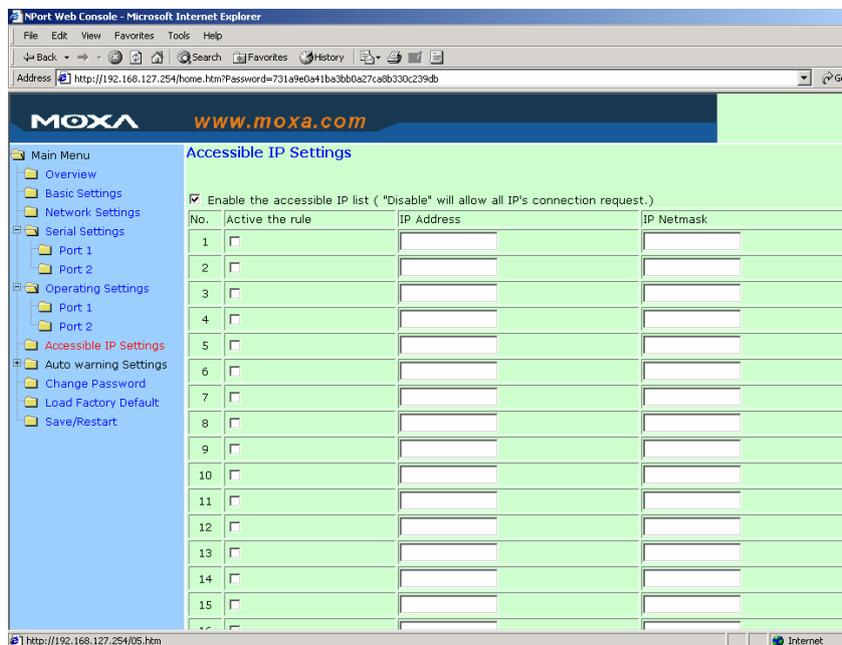
NPort 5600 использует метод фильтрации доступа к себе, основанный на контроле входящих IP адресов.
