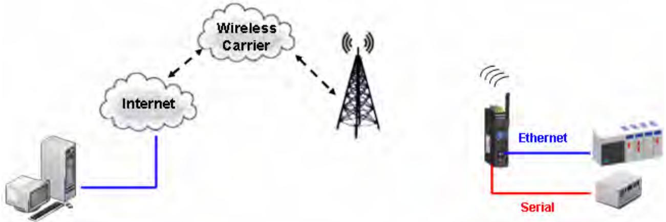
Для передачи по сотовым сетям данных с последовательных устройств OnCell G3100 поддерживают стандарты RS-232/422/485. IP-модемы – это мини-компьютеры с процессором и поддержкой протоколов стека TCP/IP для двунаправленного обмена данными между последовательными и IP-сетями. Используя OnCell G3100, можно получать доступ к устройствам, управлять и настраивать оборудование удаленно (через сотовую сеть) из любой точки мира.
