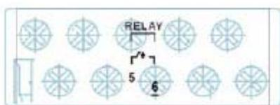
**АВАРИЯ:** контакт реле на 10-контактном терминальном блоке используется для сигнализации о событии, определяемом пользователем. Два провода, присоединенные к контакту RELAY, размыкаются, когда происходит пользовательское событие. Если такое событие не происходит, цепь остается замкнутой.
