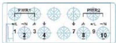
**ШАГ 1:** Вставьте положительный и отрицательный провода постоянного тока или провода L и N переменного тока в клеммы +/L и -/N терминала.
